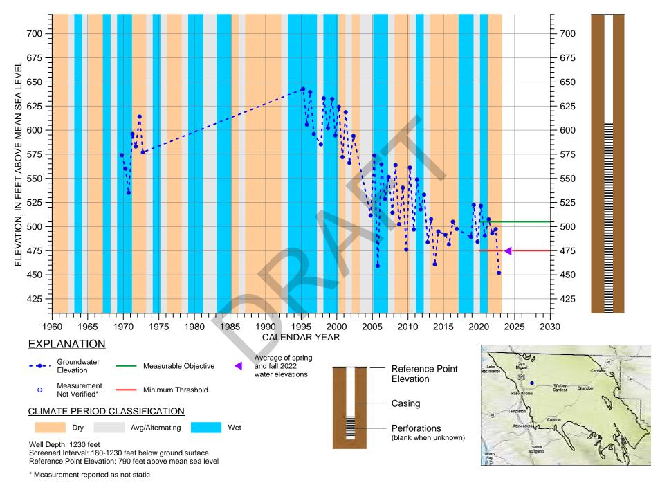
HYDROGRAPH OF MEASURED GROUNDWATER ELEVATION FOR 26S/12E-14H01
